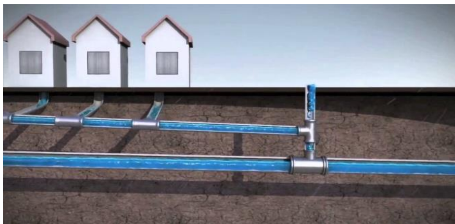
Fig 49. Grafica subterránea del alcantarillado en una poblada
