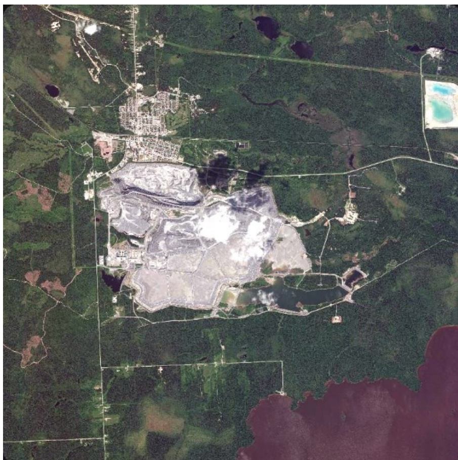
Figure 3.5 : Image RVB (Rouge = bande 5, Vert = bande 3, Bleu = bande 2) Worldview-3 centrée sur les haldes à stériles de la mine.
