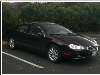
(a) Schwarze Limousinen sind für Lidarsensoren potenziell Ziele mit geringer Reflektivität
