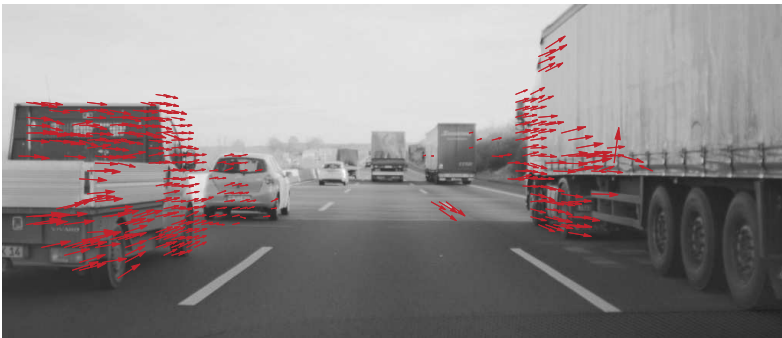
Abbildung 2.4.: Optischer Fluss (rote Pfeile) für ein Verkehrsszenario, in dem das Ego-Fahrzeug einen LKW überholt (rechter Fahrstreifen) und gleichzeitig von anderen Fahrzeugen überholt wird (linker Fahrstreifen)
