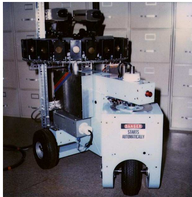
Abbildung 5.11.: Verwendeter Versuchsträger „Neptune“ mit einem Array aus 24 Ultraschallsensoren und 2 Kameras (Bild aus [Moravec 1985])
