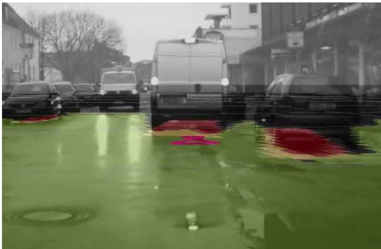
Abbildung 5.23.: Belegungsgitter der einzelnen Zellzustände in einer innerstädtischen Verkehrsszene. Die Befahrbarkeitswahrscheinlichkeit des Fahrschlauchs wird durch die beiden magentafarbenen Dreiecke dargestellt.
