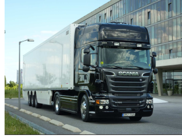
(b) Versuchsträger ausgerüstet mit Stereokamera, zwei Monokameras, fünf Radarsensoren, zehn Ultraschallsensoren, zwei Inertialplattformen, GPS und digitaler Karte
